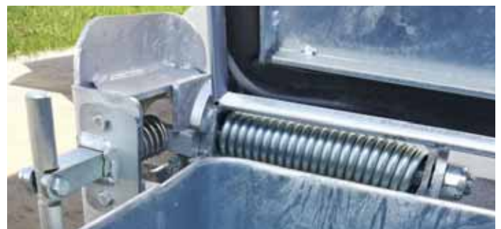
Aretace víka a pružiny nadlehčující víko
